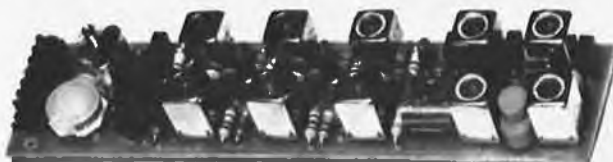
Platine HF conseillée pour être utilisée avec le codeur 7 voies LEXTRONIC ci-dessous
